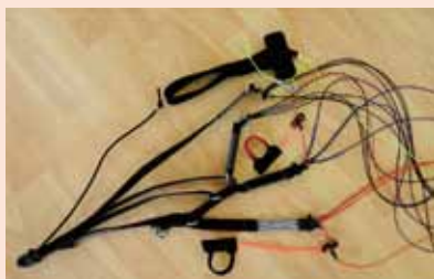
Les petites poignées scratchées permettent d'agir sur les suspentes. À droite, un autre exemple vu chez Advance.
