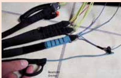
Les petites poignées scratchées permettent d'agir sur les suspentes. À droite, un autre exemple vu chez Advance.
